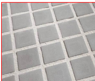
BEST AKVAGRAS, modulární skladební rozměr 200 x 200 mm (vč. spár), tl. 80 mm, pravidelné spáry šířky 30 mm, zkosená hrana (fazeta), barva antracit
